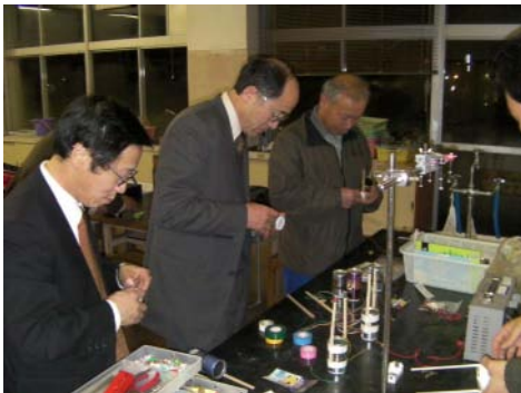
空き缶や割り箸等で、発泡スチロールカッターを作ります。
