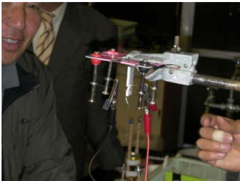
電源装置を使って、電流を変え、発泡スチロールが切れる時間を調べます。
